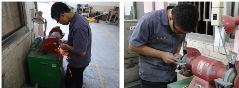
圖(三)車刀各斜角研磨
