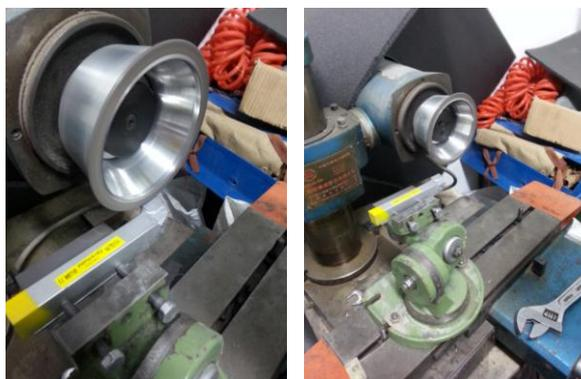
圖(四)鑽石砂輪機開槽
