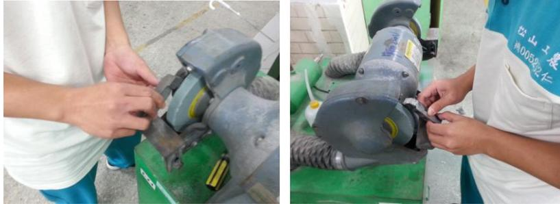
圖(五)砂輪開出完成斷屑槽
